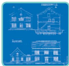
In het archief van Erfgoed Leiden e.o. vonden we het originele bestek voor de aannemer voor de bouw van de watergasfabriek (1905). Verdwenen zijn de hoge schoorsteen de twee kleinere gashouders en de ventilatiekap op het hoofdgebouw. Uit de tekening valt goed af te lezen dat het gebouw vanuit een productieproces is ontworpen.
